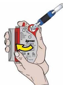
3. Rotación de la compuerta e introducir el cable dentro del anticaídas.
