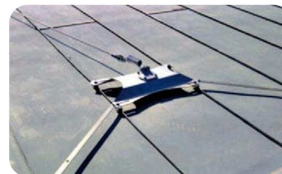
Em alguns casos, é necessário reforçar as ancoragens finais ou os cantos das linhas de vida com braços de reforço. Estes braços repartem melhor a força de queda numa maior superfície de cobertura. Necessita de indicar a separação entre juntas da cobertura para seleccionarmos correctamente o comprimento dos braços.
