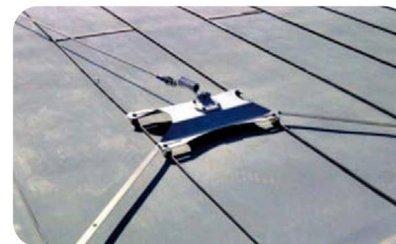
In alcuni casi è necessario rinforzare gli ancoraggi delle estremità o degli angoli della linea vita con bracci di rinforzo. Questi bracci distribuiscono meglio la forza di caduta su una superficie più grande della copertura. Occorre indicare la separazione tra le giunture della copertura per la scegliere la lunghezza dei bracci.
